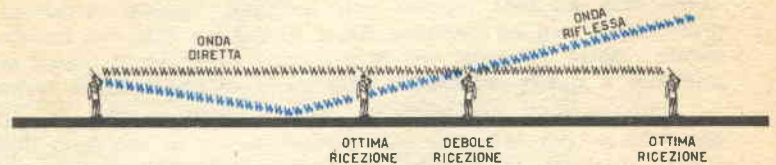
Fig. 12 - Ecco un esempio simile a quello di figura 11: se il punto di ascolto viene spostato, può succedere, grazie alla presenza di due onde radio, che la ricezione vari di livello e possa essere MIGLIORE a distanza MAGGIORE di quella precedente. Questo fenomeno è molto accentuato sulla gamma delle onde ultracorte.
