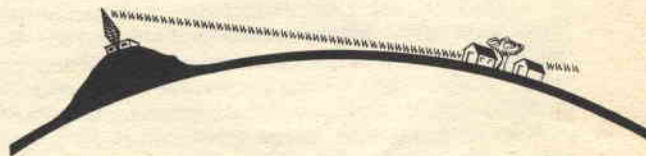
Fig. 3 - Per poter ovviare all'inconveniente sopra citato, tutte le emittenti che adottano le onde ultrasorte (ad esempio le emittenti televisive) vengono installate il più in alto possibile.
