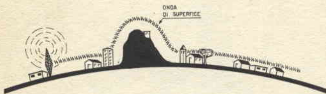
Fig. 1 - Le onde medie fino alla frequenza dei 3 MHz (100 metri) si propagano sfruttando l'onda di superficie, che asseconda rilievi e depressioni del terreno.
