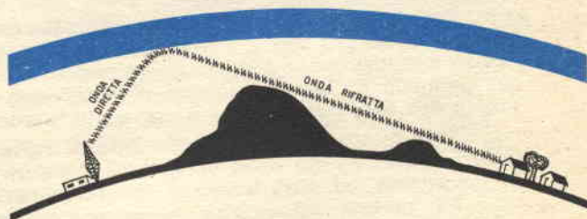
Fig. 4 - Le radioonde possono a volte essere rifratte dagli strati superiori dell'atmosfera (troposfera) ed esse ritornano sulla superficie della terra a considerevoli distanze dal punto di emissione superando ostacoli anche molto consistenti.
