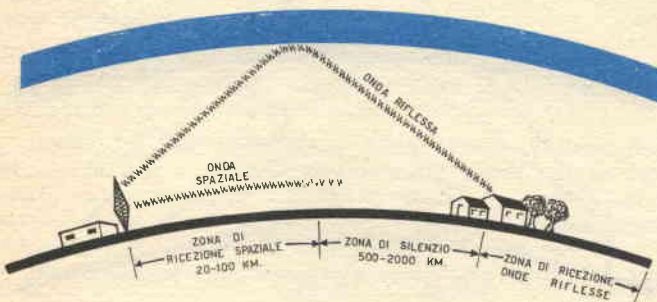
Fig. 22 - Le onde cortissime man mano che proseguono nell'atmosfera si affievoliscono d'intensità sino a perdersi. A questo punto ha inizio la ZONA di SILENZIO che termina soltanto nel punto di ritorno sulla terra dell'onda riflessa dalla iono-sfera.
