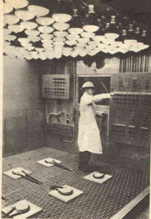
Fig. 3 - La prova di « pieno sole » su cavi di alimentazione sistemati su supporti di legno, è qui eseguita da un tecnico che sta appunto regolando l'intensità « solare ».
