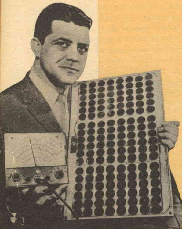
Una combinazione serie-parallelo di 144 cellule solari al silicio può fornire, alla luce del sole, una potenza di 5 W a 6 V ad un sistema di batterie.
