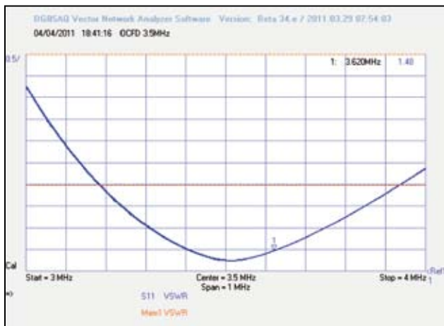
Fig. 11 - SWR misurato in banda 3,5 MHz
