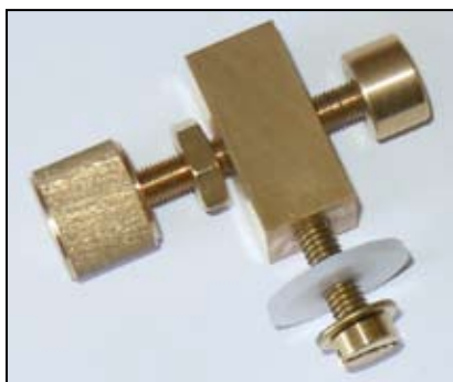
Particolare dello smorzatore delle oscillazioni del braccio oscillante. Si noti la rondella in delrin.
