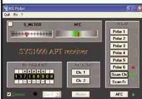
Ricevitore a sintesi da 130 a 139 MHz Decodifica dati gestita da microprocessore. Programma per PC in ambiente Windows. Gestione automatica di Meteosat e Polari. Dialogo con PC tramite seriale RS232. Alimentazione 15 / 18 volt cc o ca.
