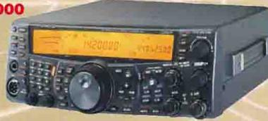
Opera su cinque bande: HF, 50 MHz, 144 MHz, 430 MHz (1.2 GHz opzionale). L'accordatore d'antenna automatico entrocontenuto può essere abilitato sia in ricezione sia in trasmissione. 300 locazioni di memoria più un canale di chiamata per ogni banda. Funzioni dedicate alle operazioni via satellite. Ricezione contemporanea su bande diverse. Processore di segnale AF. TNC compatibile con il protocollo AX25.
