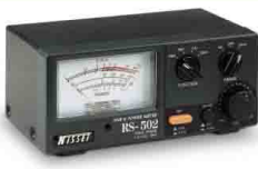
RS-502/RS-102/RS-101 Misuratore di potenza e ROS
