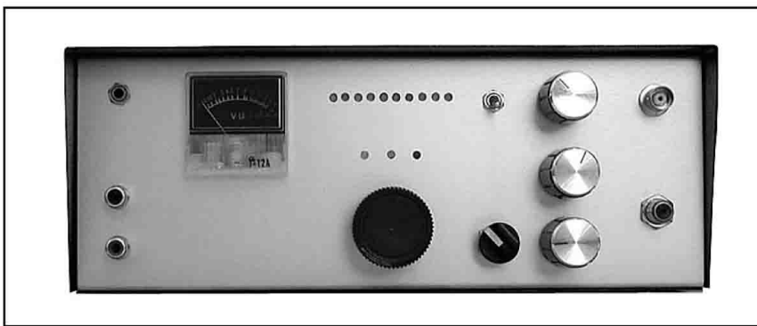
Foto del ricevitore montato in una scatola metallica per prototipi.
