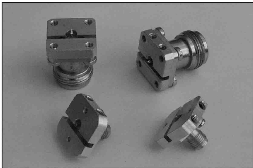
Fig. 2 - Alcuni esemplari di lanciatori con connettori N e SMA realizzati a lima e con la fresa
