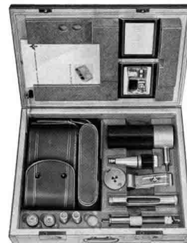
Misuratore di radiazioni GEIGER FH40T TIPO 2
