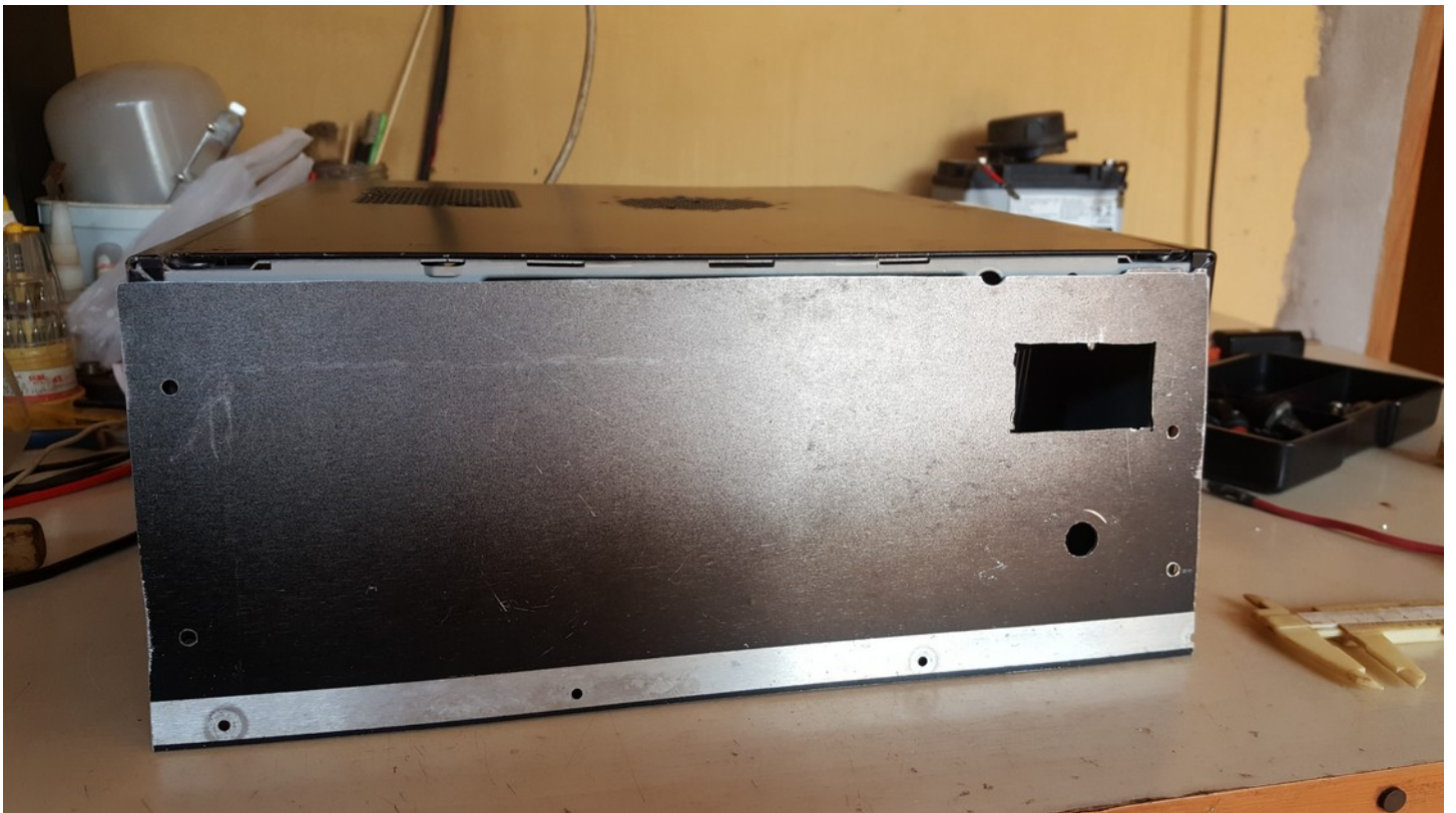
O painel foi cortado de uma caixa de alumínio de quase dois mm de espessura. Cortamos na tico-tico e fizemos o furo do voltímetro seguindo as dicas dos serralheiros. Pensa numa coisa difícil de fazer! Tudo torto...
