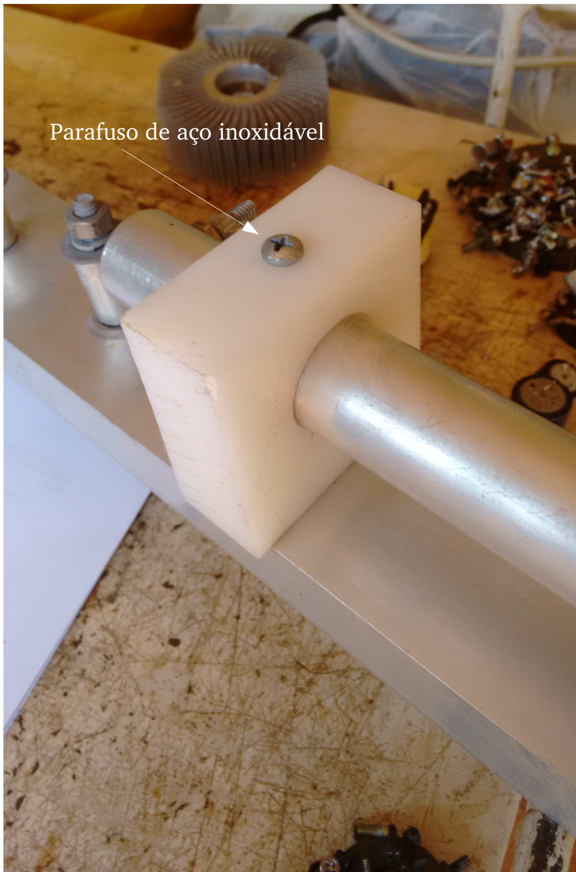
Detalhes do bloco de náilon. Veja que ele é aparafusado por baixo, com parafuso de rosca soberba e em cima um outro parafuso que ajuda a prender o tubo de alumínio de 25 mm.
