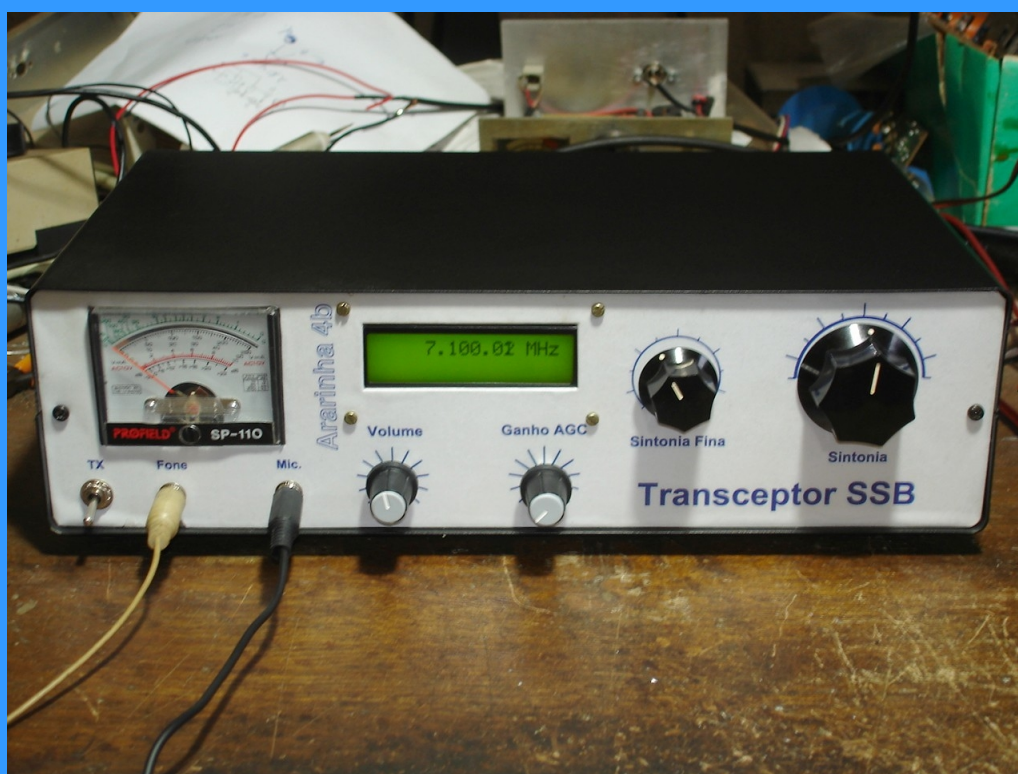
Ararinha 4b: Transceptor de SSB desenvolvido pelo nosso prolífero amigo Miguel PY2OHH. O transceptor foi dividido em três placas, sendo uma para o receptor/gerador de SSB, outra para o PA e a última para o VFO.
