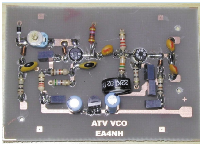
Figura número nueve: Prototipo del VCO terminado.
