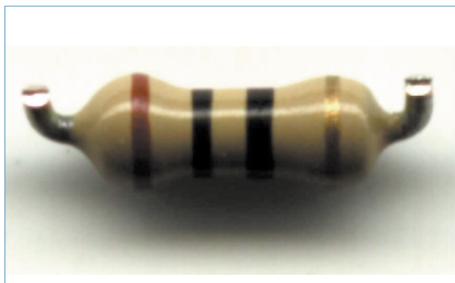
Figura número siete: Resistencia lista para soldar.
