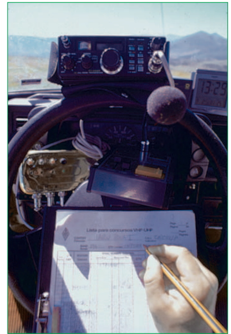
Situación de los equipos en el "puesto de operación". Observad la ridícula sencillez: la lata es el grabador digital temporizado de voz para las llamadas.
