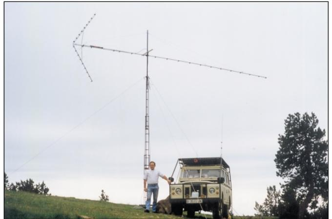
mente es imposible, por lo que al menos el sistema radiante, rotor de antena a cuerda y polea, es más rápido, más fiable y consume menos. Torreta telescópica de 5 m. de altura, tres tramos de 2 m., encima de la torreta dos directivas con reflector en un mismo larguero de 12 m. Una vez montadas y ajustadas a unos dos metros del suelo, las elevo mediante un sistema de poleas con la torreta telescópi-
