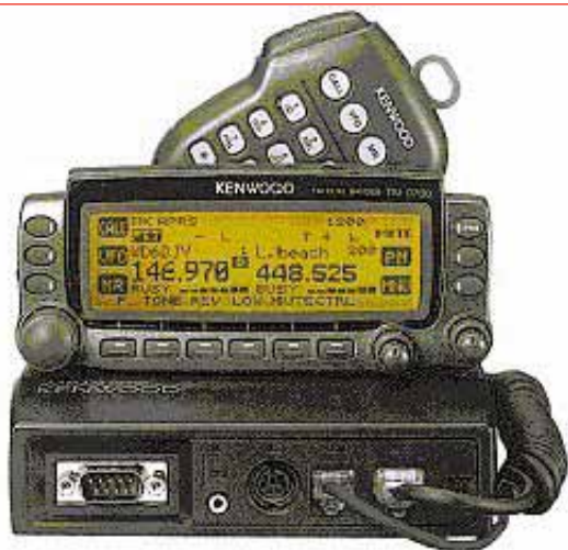
Figura 3: El nuevo TM-D700 de Kenwood. Como su antecesor el TH-D7 es un doble-banda con TNC incorporado y módem a 1k2/9k6 bps. Incorpora modalidades digitales como APRS y otras, sin perder ninguna de las habilidades analógicas clásicas.
