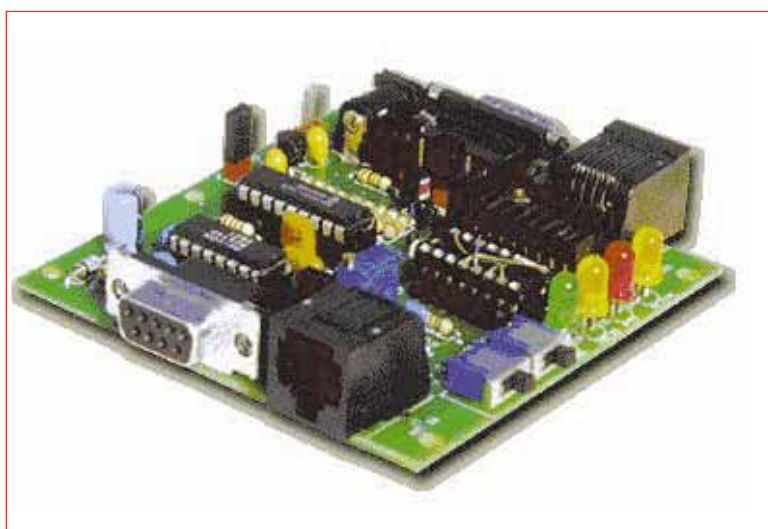
Figura 6: Pic-Encoder de TAPR. Especialmente apto para repetidores analógicos, estaciones "stand alone", meteorológicas y de telemetría.
