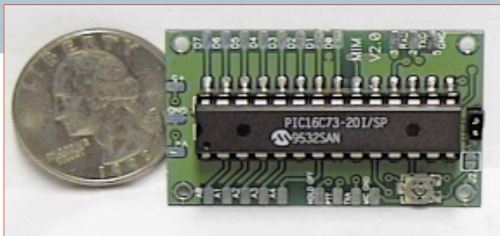
Figura 5: El MIM-Mic/Lite, completo sistema "stand alone" capaz de alojarse en el contenedor de un micrófono de mano.
