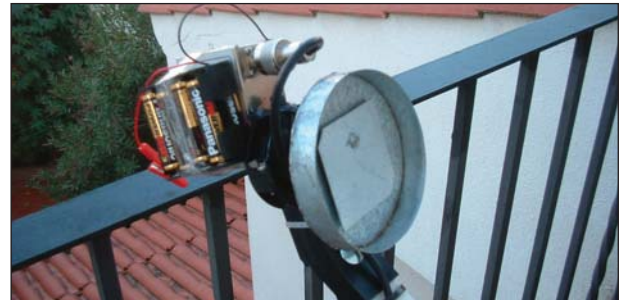
Foto 6. Patch-feed instalado con convertidor y alimentación para activación en portable de EB4DKA.
