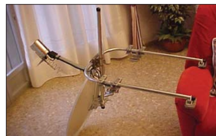
Foto 9. Detalle de la estructura soporte de la parábola con los contrapesos.
