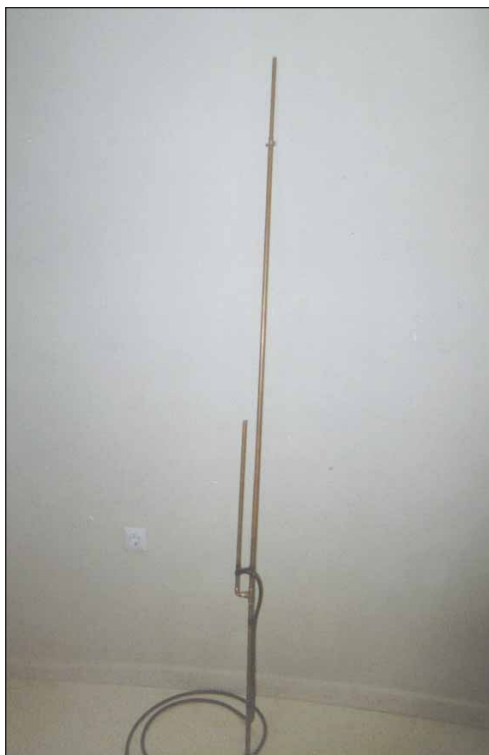
Antena Jpolo construida en cobre por miembros del radioclub antes de su pintado.
