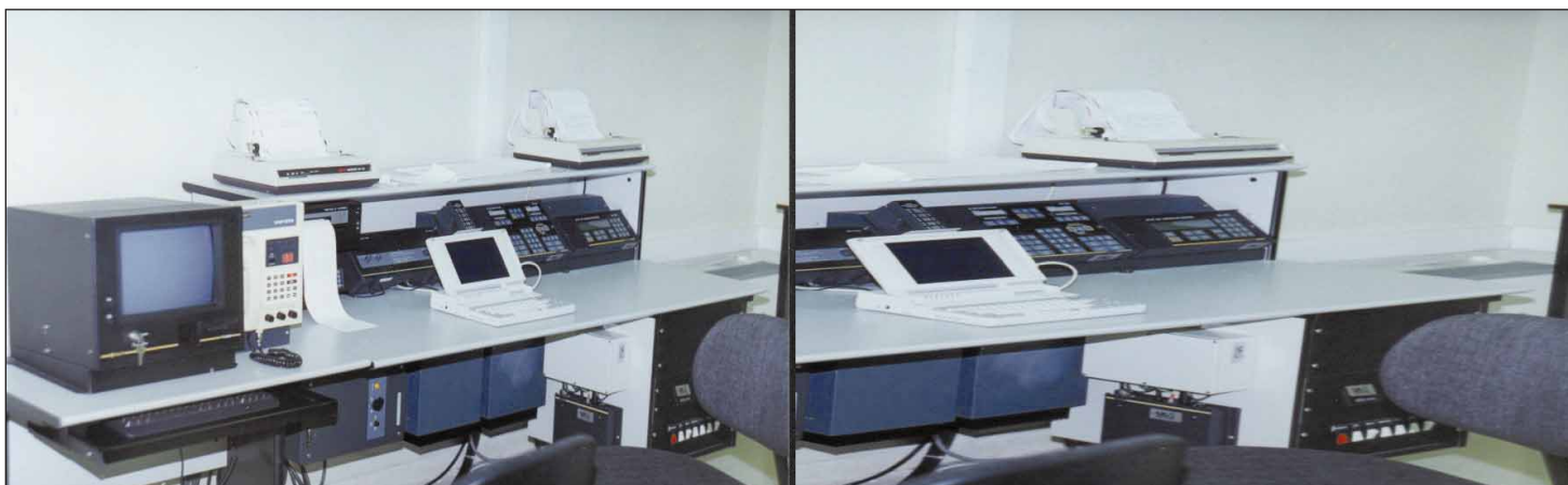
Consola de simulación del Sistema Mundial de Socorro y Seguridad Marítima.
