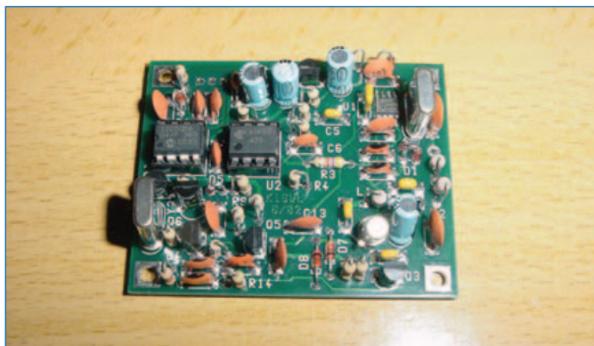
Placa ya montada
