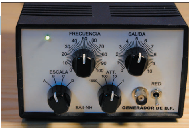
Figura 13: Generador de B.F. terminado.
