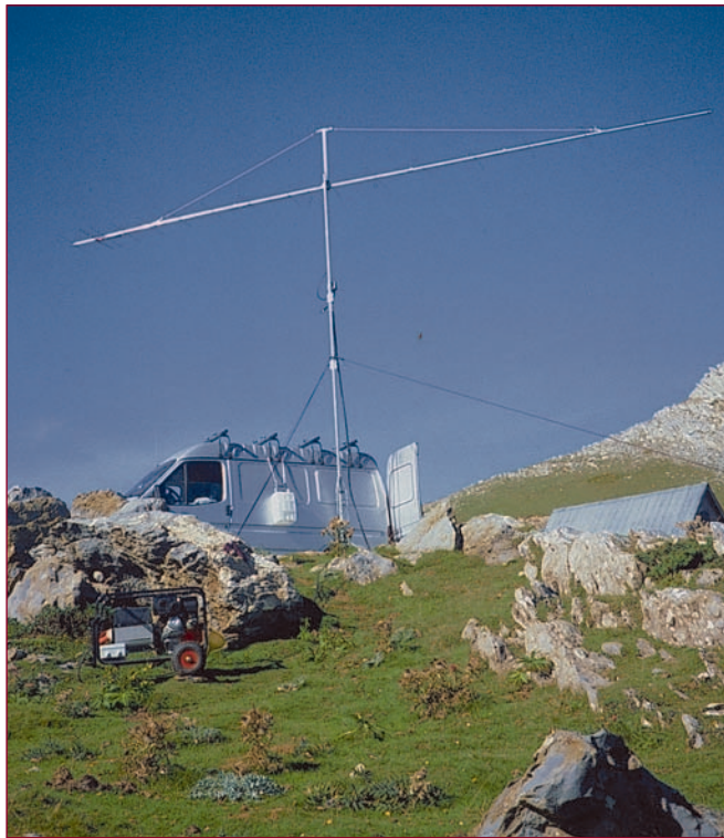
17 elementos Yagi; S.W.L. sobre 6 mts. de mástil. En primer plano potente generador de 4500 W trifásico a 220 V.
