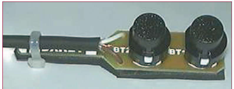
El teclado remoto, para la ejecución de las memorias.
