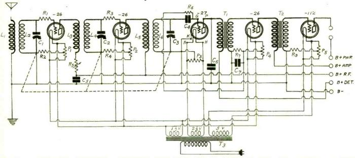
IN AN AC OPERATED RECEIVER A POSITIVE GRID BIAS CAN BE GIVEN TO THE GRID OF THE —27 TYPE DETECTOR BY CONNECTING THE CATHODE TO THE NEGATIVE SIDE OF THE POWER SUPPLY AND THEN CONNECTING THE GRID LEAK RETURN TO THE HIGH VOLTAGE END OF ONE OF THE GRID BIAS RESISTORS. (R7 ABOVE.) THE POSITIVE BIAS ON THE DETECTOR THEN HAS THE SAME VALUE AS THE NEGATIVE BIAS ON THE FIRST AUDIO AMPLIFIER.
