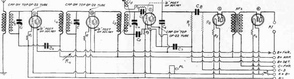
THE CIRCUIT DIAGRAM OF THE FIVE TUBE SCREEN GRID DIAMOND OF THE AIR.
