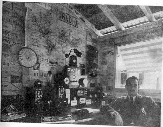
Foto da estação de Radio do Dr. Lorena Martins (PY 1 IF) — Caixa 2973 — Rio — Usa como transmissor um circuito TP TG com duas valvulas associadas em «contração» (Push Pull): como receptor, um regenerativo todo A. C. (made Home). Já foram trabalhados, todos os continentes e bem assim todos os Distritos Americanos e Canadenses, varias vezes.
