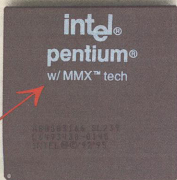
Bild 2: Das ist er also, der MMX 166. Der 200er seiner Familie gleicht optisch dem 200er Pentium-S.
