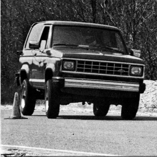
O Bronco II mostrou forte tendência a subesterçar, quando forçado nos testes de alta e baixa velocidade.
