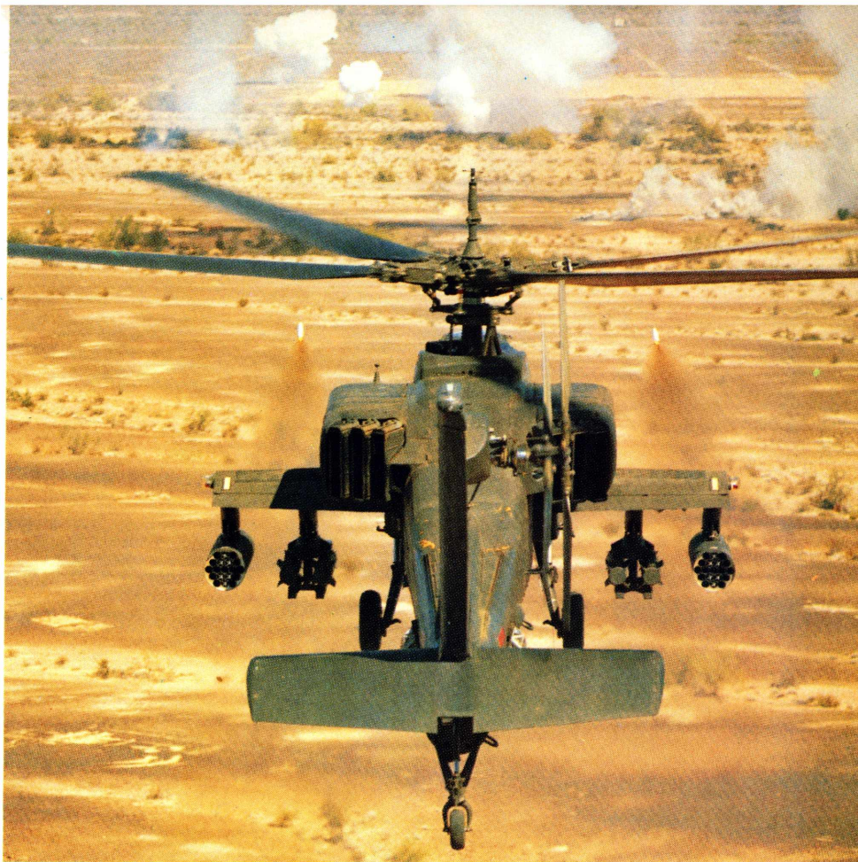
Helicóptero de ataque da Hughes dispara contra alvos foguetes orientados por mira de vídeo. O Apache AH64A voa no topo das árvores e possui sensores especiais para vôo noturno.
