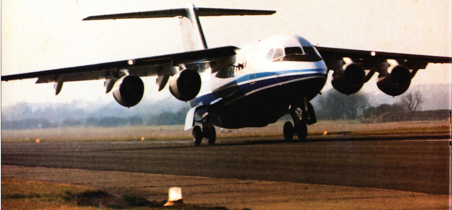
Quatro turbofans propulsionam o BAe 146 da British Aerospace, um jato para 100 passageiros feito para vôos curtos de 250 km.
