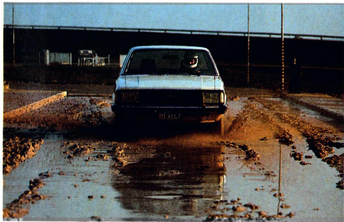
Pista de lama salgada - teste de corrosão acelerada.
