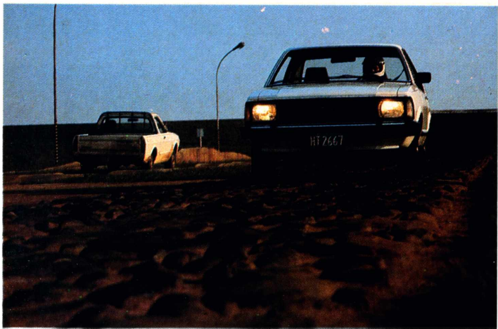
Pista de pedras desalinhadas - teste de resistência da carroceria.
