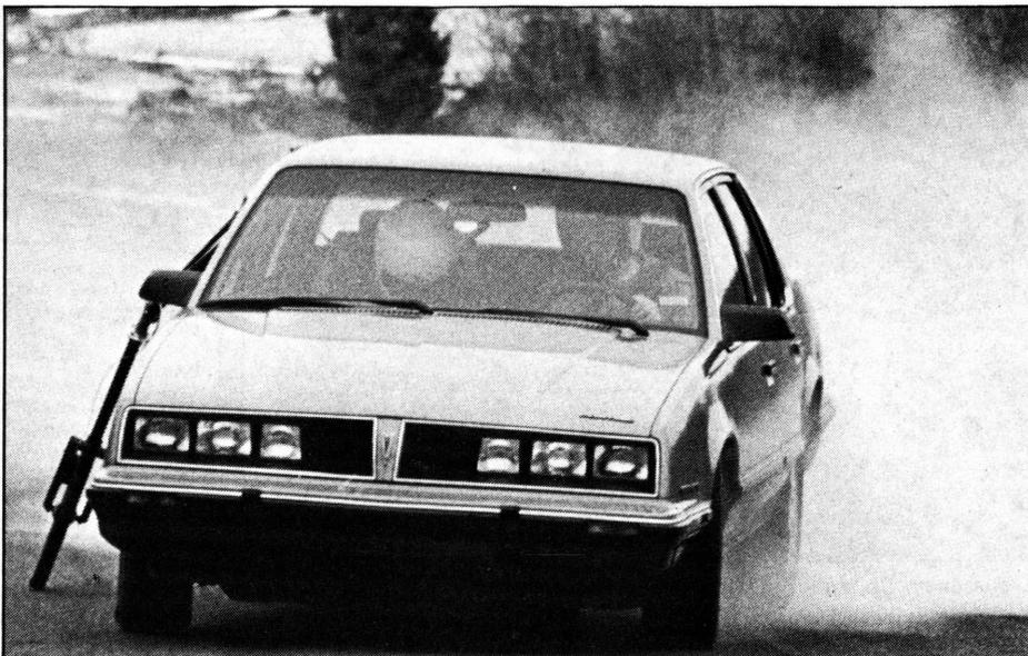
O Pontiac 6000 STE mostra a clara tendência de derrapar de traseira nas freadas pánicas de 100 a zero. Rápidas correções no volante ajudam a manter o controle.
