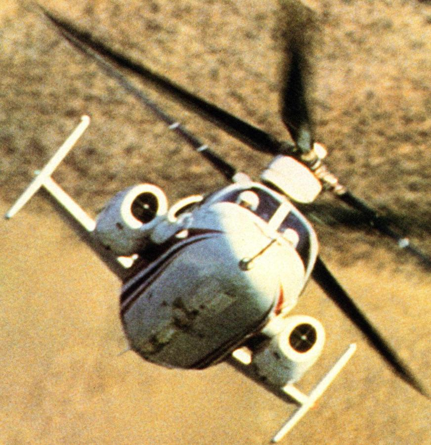
**O helicóptero ABC** atinge a velocidade máxima de 250 nós (450 km/h) (contra 150, 270 na maioria dos helicópteros) e velocidade de subida de 500 pés (1 500 metros) por minuto (os helicópteros convencionais sobem à razão de 300 pés (900 metros) por minuto).
