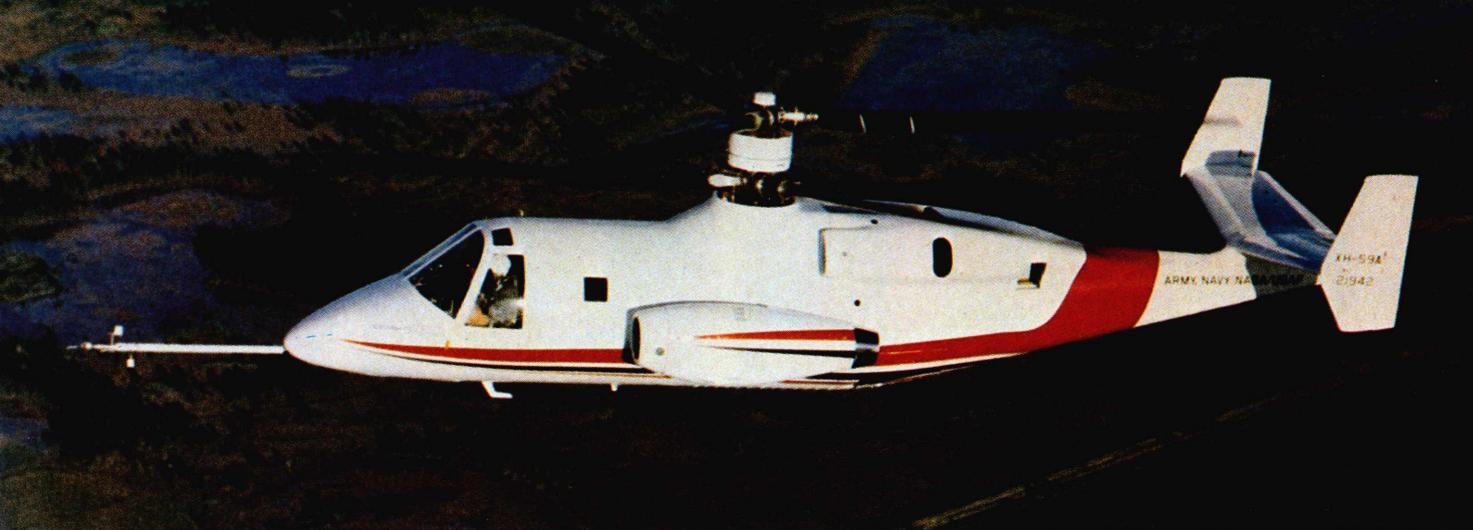
O ABC, com a mesma potência e diâmetro de rotor, oferece 10% a mais de força ascensional que um helicóptero convencional. Em algumas variações, a estrutura deste helicóptero fica incluída no disco do rotor. Essa compactidade aumenta a manobrabilidade.
