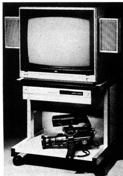
O receptor-comutador pode ser colocado debaixo do monitor, no sistema Sears. A montagem vertical (a prateleira é opcional) elimina os problemas de espaço causados pelos componentes.
