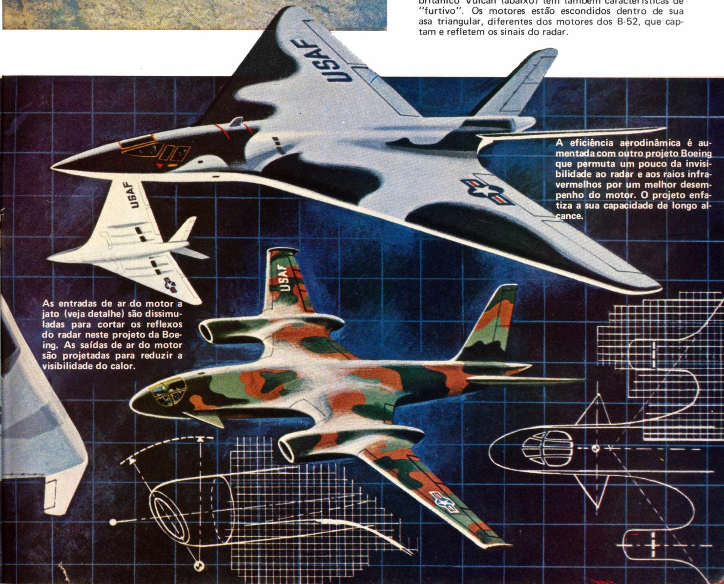
As entradas de ar do motor a jato (veja detalhe) são dissimuladas para cortar os reflexos do radar neste projeto da Boeing. As saídas de ar do motor são projetadas para reduzir a visibilidade do calor.
