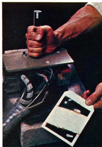
Com um lampejo e um estampido igual ao de uma pistola, este raio gigante de luz estroboscópica remove camadas de tinta, corrosão e incrustações.
