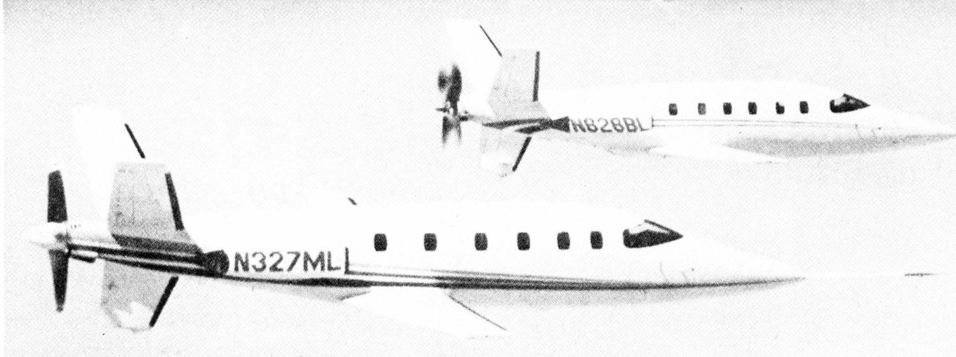
Protótipo do Lear Fan 2100, construído em grande parte de composto de grafite, é uma aeronave comercial quase invisível ao radar.
