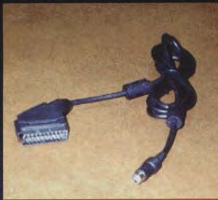
Με καλώδιο SCART παρακάμπτετε το θέμα κωδικοποίησης σε PAL ή NTSC, φτάνει να έχει ανάλογη υποδοχή η τηλεόρασή σας.
