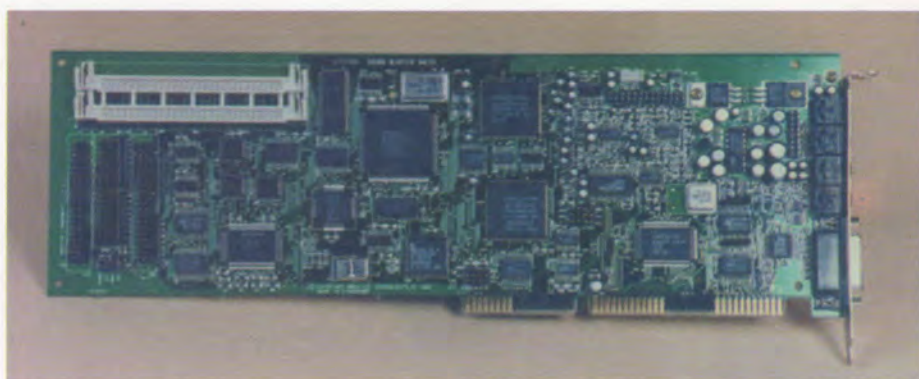
Πολύ καλή ποιότητα κατασκευής και εντυπωσιακή όψη. Ανω αριστερά διακρίνονται οι δύο λευκές βάσεις για τα SIMMs επέκτασης της μνήμης.
