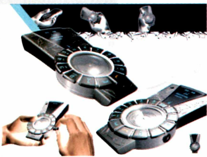
Atlas Kinetic: energia para o telefone é retirada dos movimentos do usuário
