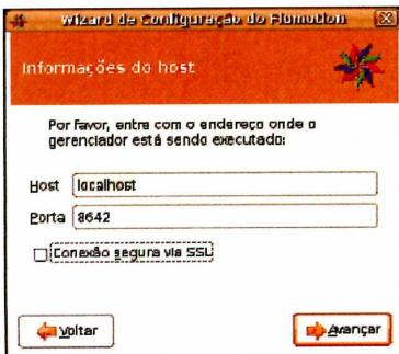
É possível configurar o Flumotion a partir de outra máquina, desde que o gerenciador esteja disponível na rede. Para isso, informe endereço IP onde o manager está rodando e desmarque a opção "Conexão segura via SSL".
