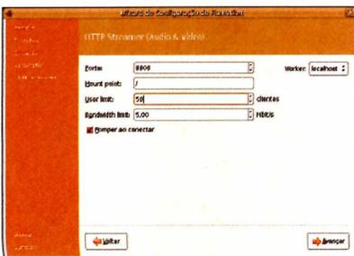
Nesta tela, deve-se completar as configurações HTTP do streaming (porta, ponto de montagem, limite de usuários e limite de banda). O nome do streaming não precisa ser preenchido.
