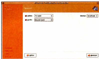
Avance pela tela de boas-vindas para chegar na configuração das fontes de áudio e vídeo. Para o canal de vídeo, é possível escolher entre um arquivo de teste, uma webcam, uma placa de captura ou uma câmera firewire. Já para o som, as opções são um som de teste, uma captura pela placa de som ou pela interface firewire.
