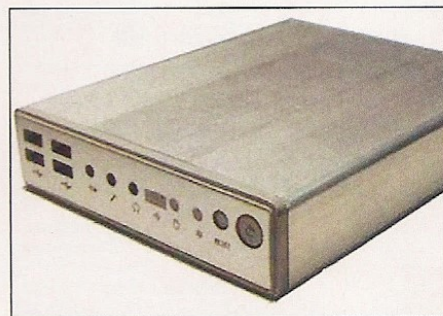
O Muncator não conta com monitor. Ele apresenta saídas para o usuário conectá-lo ao televisor
