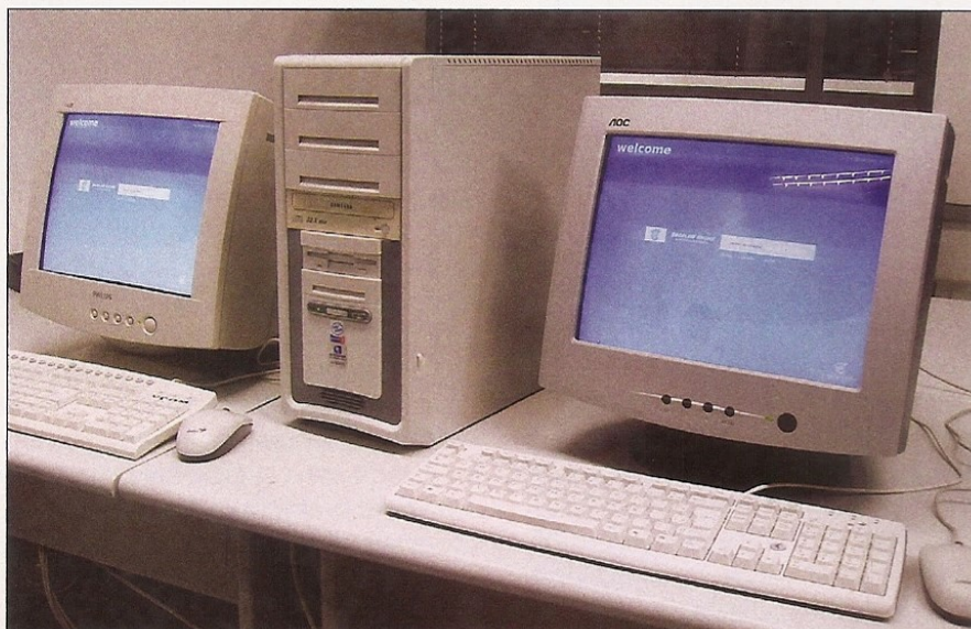
Foto: divulgação Ao configurar um sistema para utilizar os recursos de multiterminal disponíveis no Linux, o usuário pode ver seu equipamento duplicado, sem perder performance e ainda economizar um dinheiro com a aquisição de hardware
