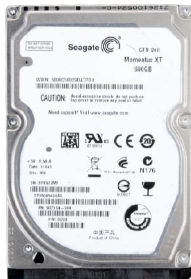
O leitor pode estranhar a presença deste HD entre tantos SSDs. Explicamos: quem ainda não ouviu falar do Momentus XT, trata-se de um HD Híbrido, um misto de tecnologia mecânica e de estado sólido. O propósito de unir o desempenho de um SSD com preço e capacidade de um HD. Para isso, utiliza uma quantidade de 4 GB de memória SLC NAND flash integrada a um disco de 7200 RPM. Por causa dessa porção de memória flash, o incluímos nos testes.
