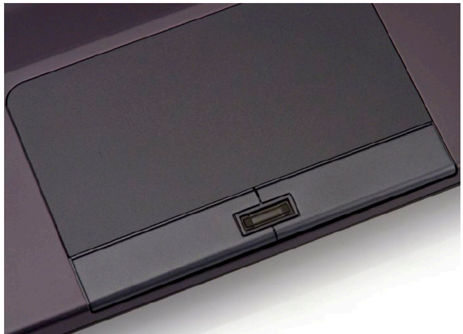
F4. Sensor biométrico adiciona uma camada de segurança para o notebook.
