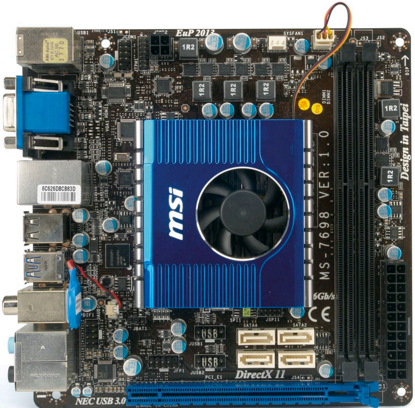
F1. Qualidade de construção: apenas capacitores com eletrólito sólido.
