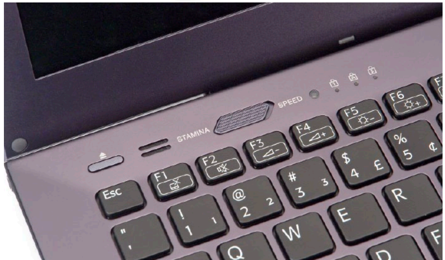
F3. O botão para desligar a placa gráfica fica na parte superior do teclado.
