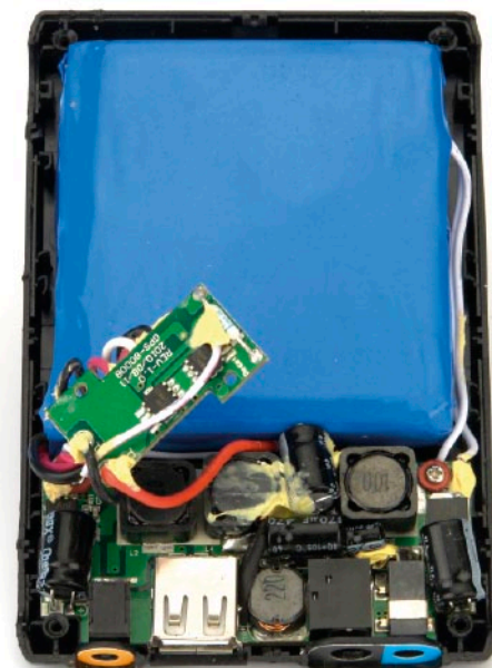
F1. Charger Pro por dentro: uma enorme bateria e um circuito regulador.
