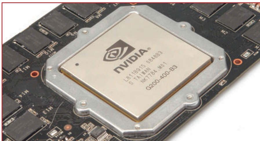
F2. Detalhe GPU GT200b da NVIDIA; 1,4 bilhão de transistores espremidos em um área de 487 mm 2 graças ao processo de fabricação em 55 nm.
