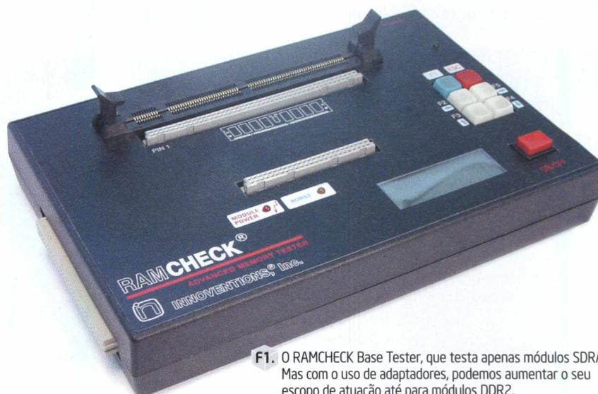
F1. O RAMCHECK Base Tester, que testa apenas módulos SDRAM. Mas com o uso de adaptadores, podemos aumentar o seu escopo de atuação até para módulos DDR2.
