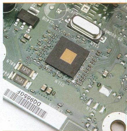
F7. Testes feitos na placa-mãe DQ965GF, que é compatível com o AMT 2.0; no detalhe, chip de rede Intel 82566DM responsável pelo acesso out-of-band.
