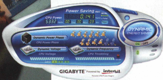
F2. Leds na placa reportam indiretamente o uso do processador; ao lado, programa que lê informações do chip da Intersil e reporta consumo do Vcore (sempre) e economia de energia (se o processador não estiver em overclock).
