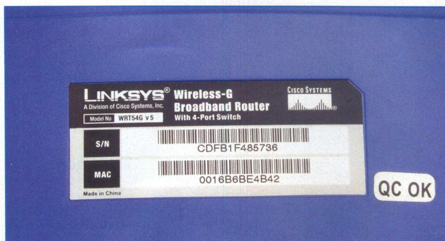
F2. Etiqueta indicativa da versão; infelizmente o nosso é da quinta versão, extremamente limitada se comparada aos recursos disponíveis nas demais.
