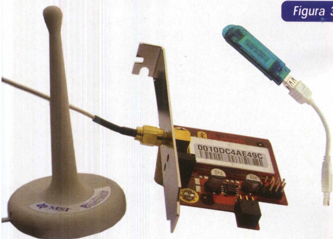
Figura 3 Kit PC2PC Bluetooth: Placa, chave com interface USB e antena.
