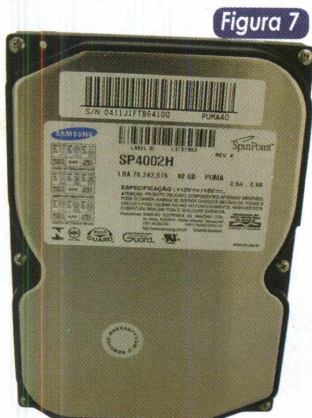
HD Samsung UDMA 100 de 7.200 RPM, "Made in Brasil", e Pente de memória DDR-SDRAM 266MHz da Itaucom.
