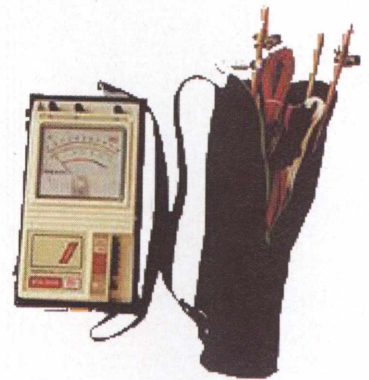
Terrômetro ou "Megger" (modelo MTA1000 da Megabras).
