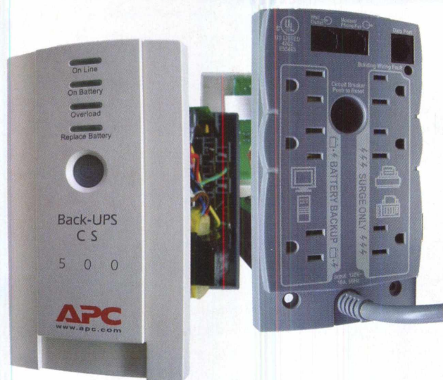
Um no-break off-line (modelo BK-500 da APC).
