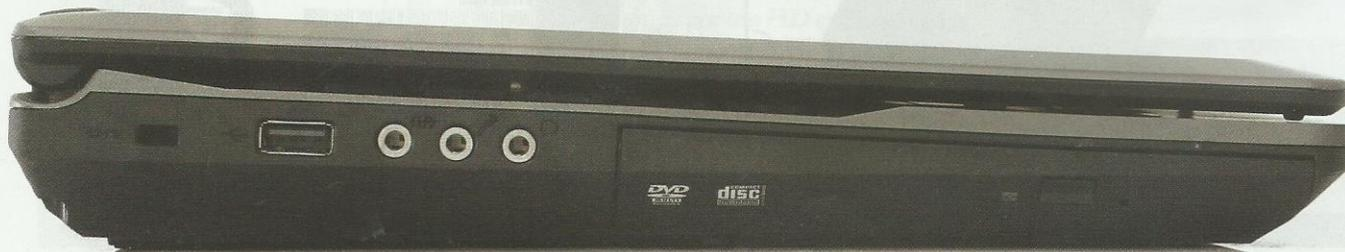
**F4.** Poucas conexões ficam no lado esquerdo do Titanium.
