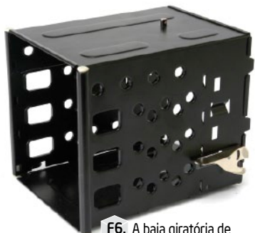
F6. A baía giratória de HDs internos é presa com uma presilha e um parafuso.
