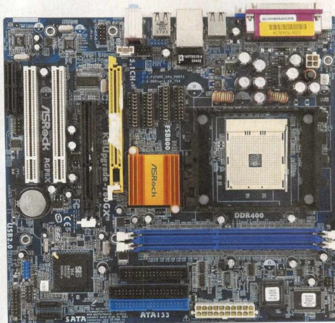
**1-** O primeiro passo para fazer a troca da placa-mãe é desligar seu computador da tomada. Desplugue todos os cabos e abra o gabinete do PC. Alguns cases não usam a proteção inteira, se esse for seu caso, retire todas as placas laterais com o auxílio de uma chave Philips. Antes de tocar nas peças, encoste nas placas de metal do PC. Isso irá ajudá-lo a se livrar da eletricidade estática, que pode danificar os componentes.
