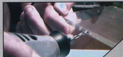
**4** Escolha um lugar na base para posicionar o interruptor que vai ligar e desligar os Leds da Stand Light. Com a Dremel, forme o buraco onde será encaixado o interruptor. Mas lembre-se: a cavidade deve ter o tamanho exato do seu interruptor, sem folgas.
