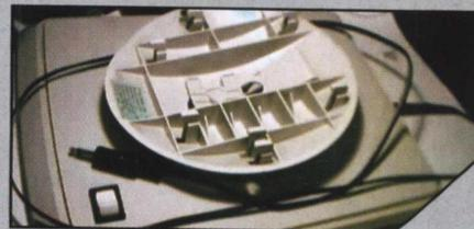
**13** Se os Leds do seu Stand Light não acenderem, é porque você inverteu os fios fase e neutro na ligação do plug J2. Se isso acontecer, é preciso conectá-los novamente
