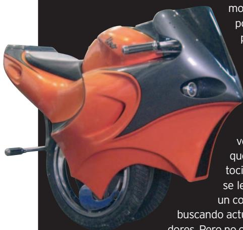
se controla mediante el movimiento del cuerpo: hacia delante para alcanzar una velocidad de hasta 40 Km/h y hacia atrás para frenar. Al parecer, se inspiró tras un viaje a China y ver la contaminación que provocan sus motocicletas. UNO, como se le conoce, todavía es un concepto y Gulak está buscando actualmente patrocinadores. Pero no cabe duda de que los
