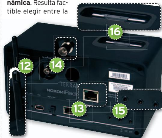
conexión a través de cable de red **Ethernet 10** o bien **WiFi 11**, aunque de nuevo, si tienes la posibilidad, opta por la primera debido a que el ancho de banda ofrecido es bastante superior.
