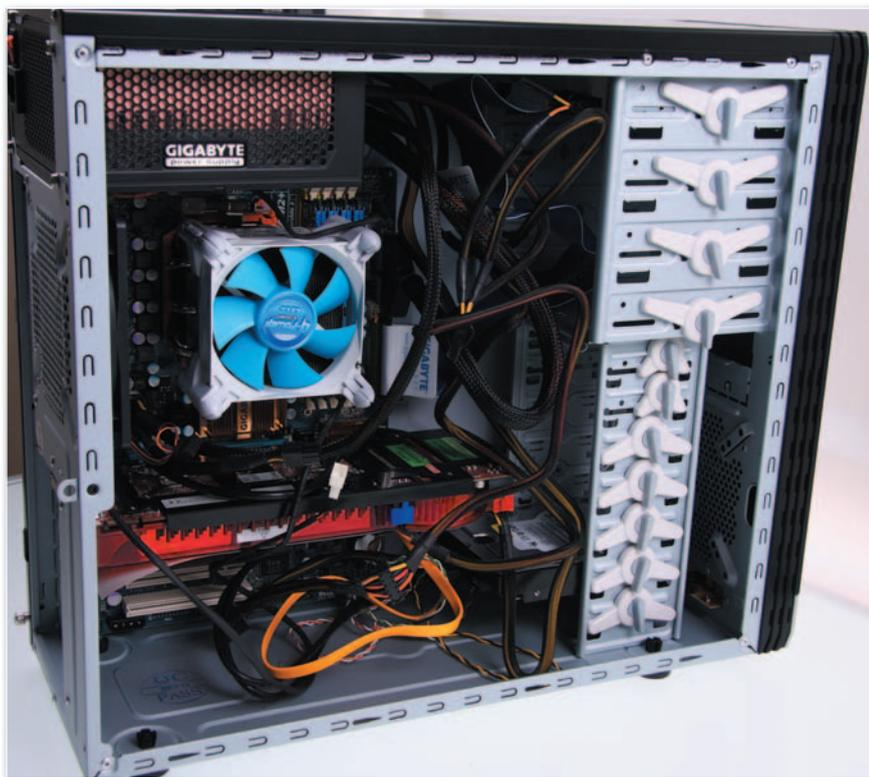
• El interior de un equipo es fundamental para garantizar una correcta refrigeración y circulación del aire. Aquí pueden verse las «tripas» del Gitan@ PC, con todos los cables a su libre albedrío, y sin agrupación alguna, lo que dificulta la refrigeración.
