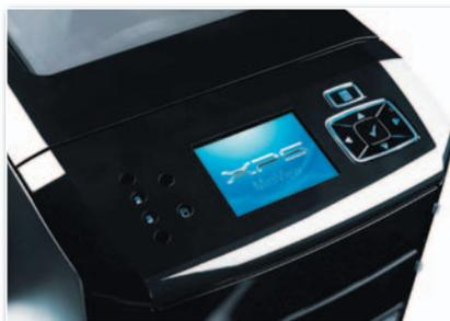
• En la imagen tenéis en detalle la pantalla de Dell para la función SideShow de Vista, un poco inútil en un PC de sobremesa.
