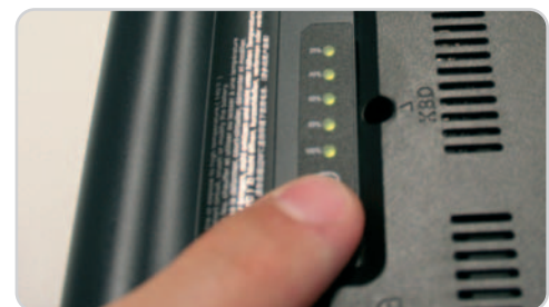
La batería de 6 celdas, aunque voluminosa, ofrece una buena autonomía. Además, integra un indicador luminoso de carga.
