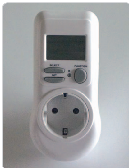
Gracias a dispositivos como este medidor de consumo eléctrico, seremos capaces de estimar los vatios que utiliza nuestro equipo en todo momento.
