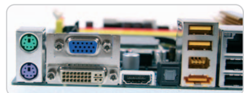
Las posibilidades de visualización de esta placa quedan patentes en este vistazo a su panel trasero: VGA, DVI y HDMI.
