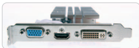
Como salidas disponemos de tres tipos de conexiones: VGA, DVI y HDMI.
