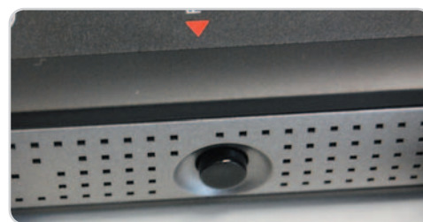
Con el botón trasero de configuración rápida activaremos la conexión inalámbrica con seguridad integrada de manera casi automática.
