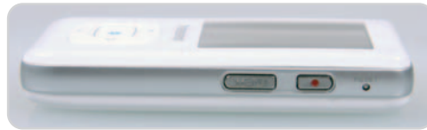
En un lateral encontramos botones de acceso rápido al menú principal, de grabación de voz y de reseteo.
