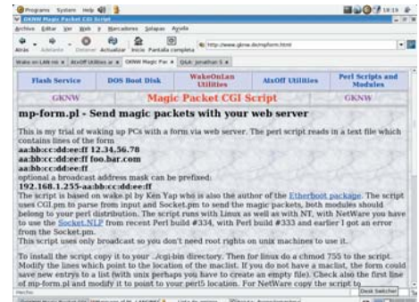
Hay utilidades para despertar a una máquina que se implementan mediante un script CGI.
