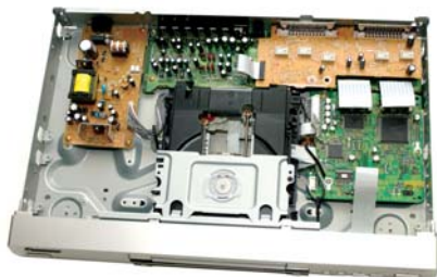
El interior del nuevo reproductor multiformato de gama media de Pioneer, el DV-565A, destaca por su elevada simplicidad y el modesto (pero acertado) diseño de su mecánica de transporte.
