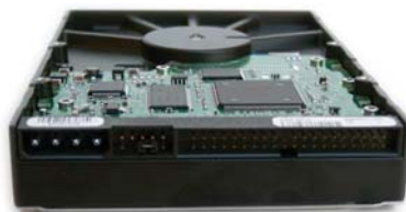
Interfaz IDE con un conector de 40 patillas y alimentación separada.
