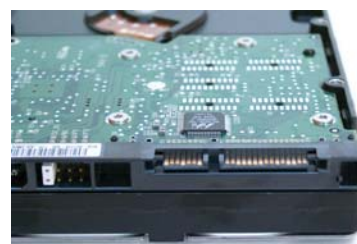
El moderno conector Serial ATA con sólo cuatro patillas y su compacto cable.
