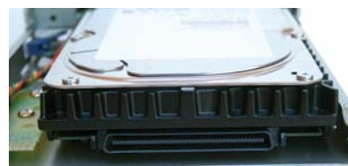
La conexión moderna SCSI engloba, en un único conector de 80 patillas, alimentación y datos.
