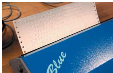
Impresora braille Porta-Thiel Blue para particulares.
