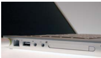
Los puertos del nuevo PowerBook G4, por fin en los laterales y al descubierto. A la izquierda, módem 56K, USB 2.0, entrada de audio, salida de audio y ranura para tarjeta PC Card.
