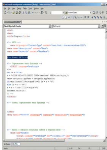
Los elementos innecesarios, como los comentarios y espacios en blanco, pueden eliminarse.
