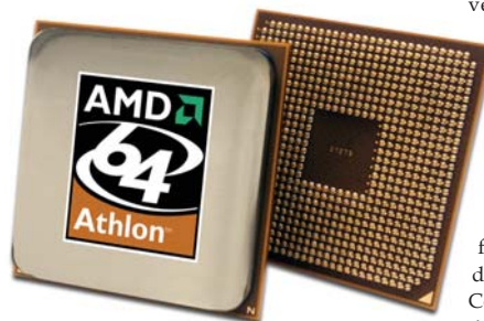
La diferencia a nivel de patillaje entre los Athlon 64 FX (940 pines) y Athlon 64 (754 pines) estriba principalmente en la integración en el modelo más potente de un controlador de memoria de 128 bits.
