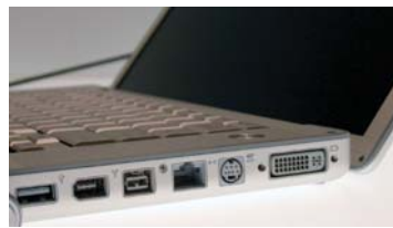
En la derecha, otro puerto USB 2.0, un FireWire 400, un FireWire 800, Gigabit Ethernet con autosensor de tipo de cable, salida S-Video Y/C y salida de vídeo digital DVI.
