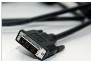
Cable normalmente proporcionado por los fabricantes de pantallas TFT. Dispone de un conector DVI-D, por lo que las señales analógicas han sido omitidas. Fijaros en la patilla transversal y en la ausencia de las que se encuentran a su alrededor.
